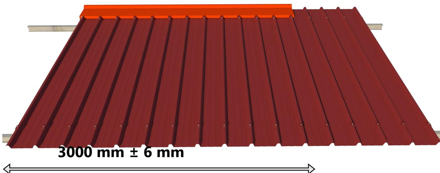
Il est très important d'avoir un parfait emboîtement des panneaux pendant la phase de montage (3 panneaux = 3000 mm ± 6 mm) afin d'éviter des problèmes lors de la phase suivante de montage des faitières. Comme montré dans l'image, la faitière est un élément de tôle à pas fixe et, par conséquent, l'absence d'un correct emboîtement des panneaux rendra difficile le couplage de la faitière avec l'onde.
